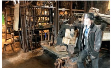
Lässig auf den Hammerstiel gelehnt, erklärte er viele Details über den Hammer. Im Anschluss konnten wir den Hammer in Aktion erleben. Mit der Falle reguliert der Schmied den Wasserfluss über das Wasserrad an der Rückseite der Schmiede und damit die Rotationsgeschwindigkeit der Antriebsachse. Auf dieser Achse befindet sich ein mit Nocken (auch Frösche) besetztes Laufrad, die den Aufwerfhammer regelmäßig anheben.
